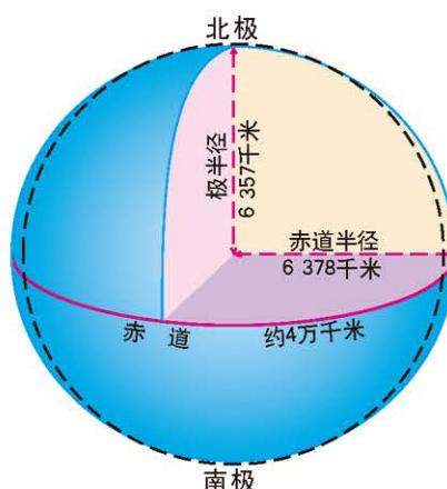
图 1-2-5 地球自转使地球形成一个椭球体
