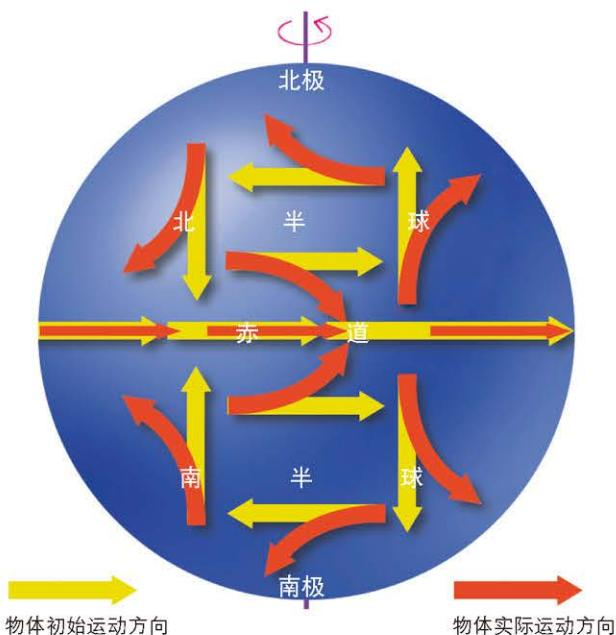
图 1-2-4 地球自转使地表水平运动物体的运动方向发生偏转
