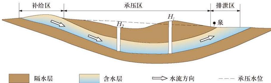
图 4-1-8 承压水盆地构造示意图
