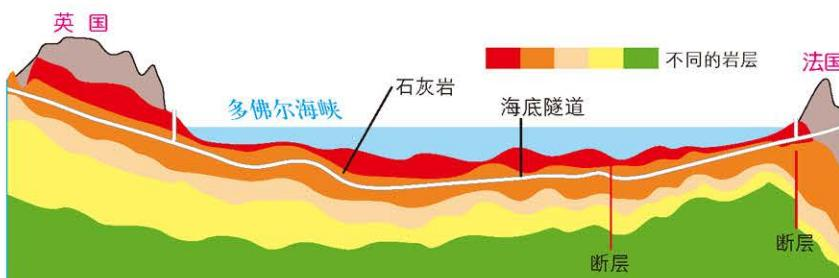
图 2-2-24 多佛尔海峡英法海底隧道横剖面
